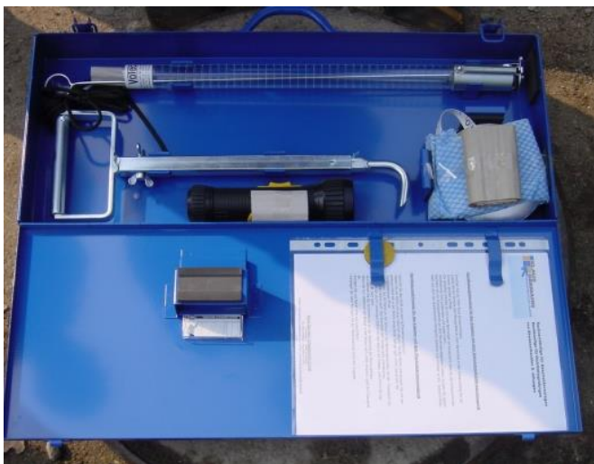
Wartungskoffer für Abscheideranlagen mit Maßband für die Schlammdickenmessung, Ölspeichermengenmesser und Schachthaken. (Foto: A. Klapproth)
