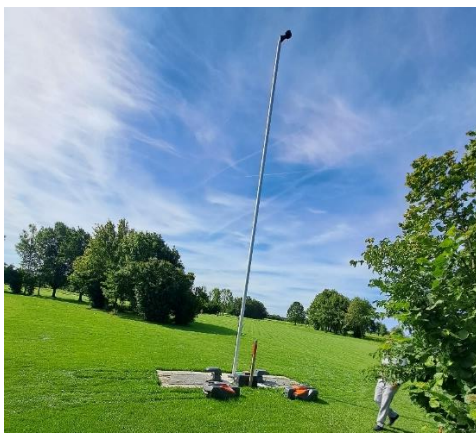
Abbildung 3: Rasenmäroboter neben einem Fairway mit Ladestation und Referenzstation auf einem Mast (Bild: ILOS)
