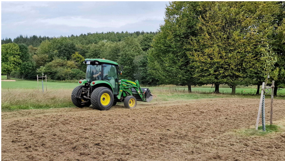
Walzen der Fläche durch die breiten Reifen des Traktors | © DGV/Petra Himmel
