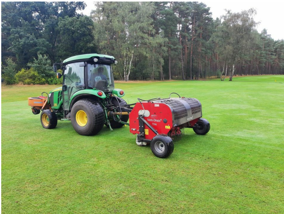
Vertidrainierung eines Fairways um die Bodenstruktur zu verbessern. | © GC St. Dionys/Christian Steinhauser
